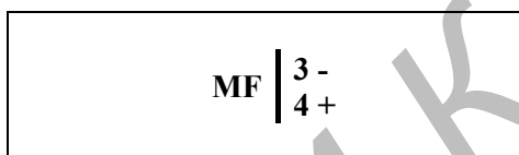
Рис. 4.6. Типовая маркировка СЧ выхода счетчиков DELTA
